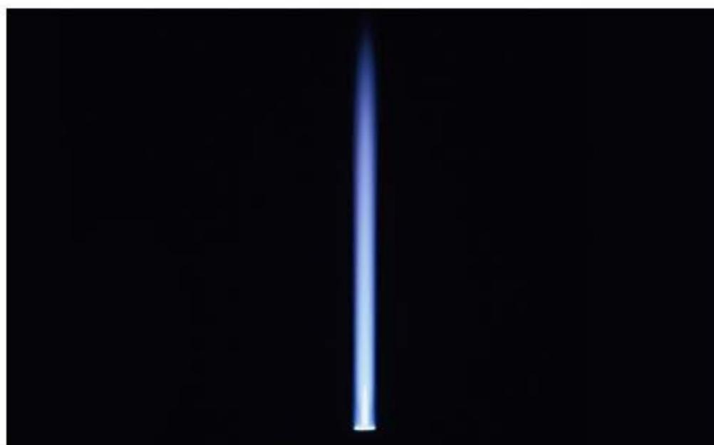
単孔バーナとしてA型やSP型より高温の火炎が必要な場合にお薦めです。空気に酸素を混合することによって火炎の温度が上昇し、硬質ガラスや石英ガラスの加工に使用できます。また、燃焼速度が大きいことから内炎長が短くなりガラスの局部加熱用に適しています。
