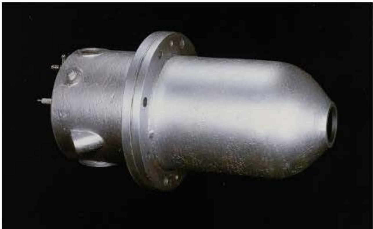
メタリックハイスピードバーナは、噴出ノズルから高温、高速の火炎を噴出し、優れた伝熱効果を発生させるバーナです。バーナ内部に設けられた燃焼室で高負荷燃焼させた高温・高速の火炎を毎秒200mの速度で噴出することから、炉内攪拌・急速加熱が可能です。よって、炉内温度分布の改善や攪拌装置が不要となる等のコストダウンなどが可能です。大きなターンダウン比を持ち、高過剰空気でも使用可能です。ターンダウンレシオ※は1:50です。温度分布が向上するため、主に溶融亜鉛鍍金炉、ベル型炉、台車炉等に適しています。常温空気用のMH型と予熱空気用のMHA型の2タイプがあります。
